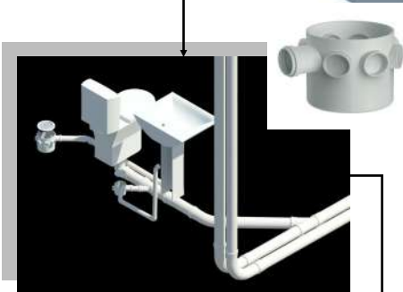
ESGOTO SANITÁRIO DESENVOLVIDO A PARTIR DO SISTEMA 3D COM ANÁLISE DE INTERFERÊNCIA
